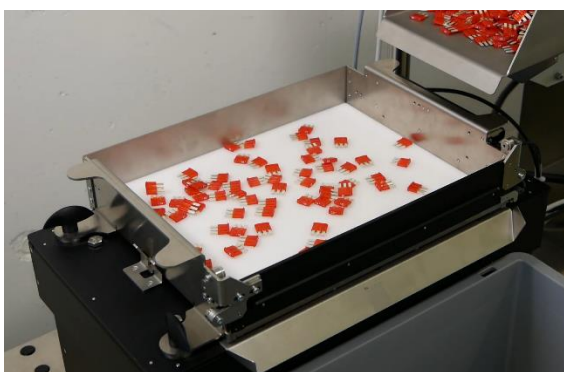
Asycube 380 mit einer geschlossenen Entleerungsplattform.
