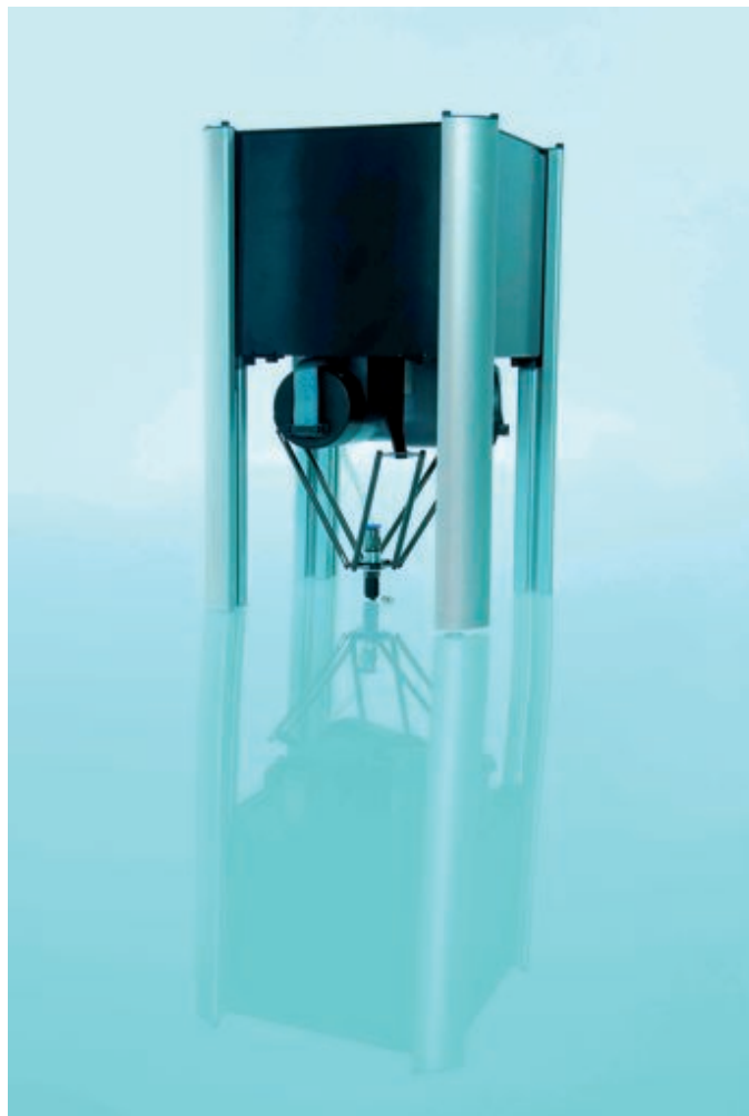
Le PocketDelta ou la micro fabrique de demain, capable d'assembler dans le domaine de la microtechnique et même vers la « nano »...
