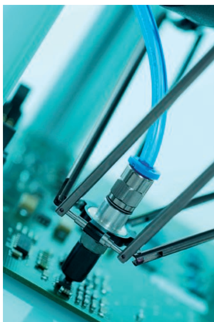
Détail sur la tête du robot dotée d'un micro-aspirateur lui permettant de positionner avec précision des composants électroniques.
