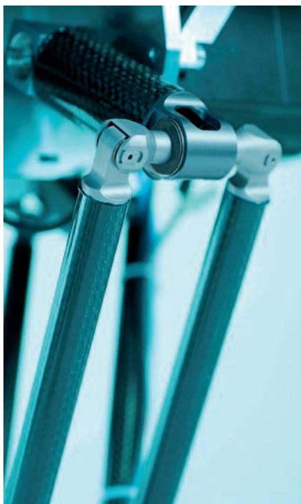
Détail d'une rotule.
