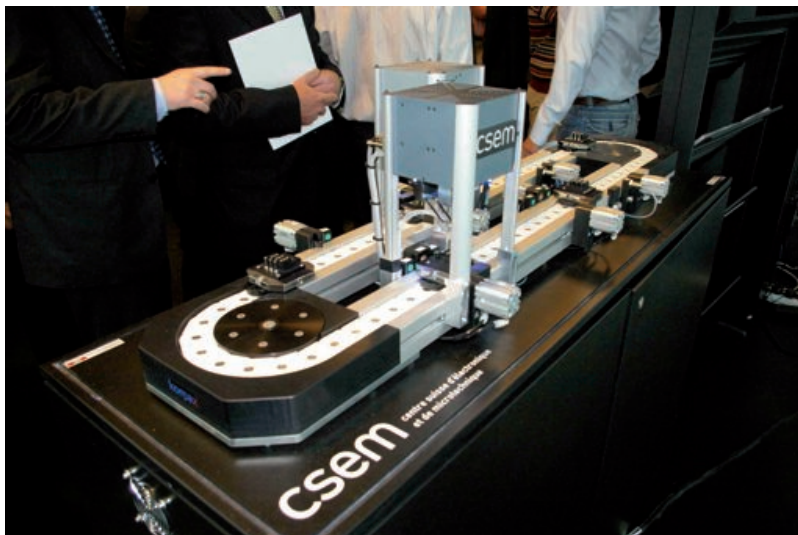
Le PocketDelta et ses jumeaux peuvent être placés le long d'une ligne de montage automatique et concrétiser par là la micro fabrique de demain.
