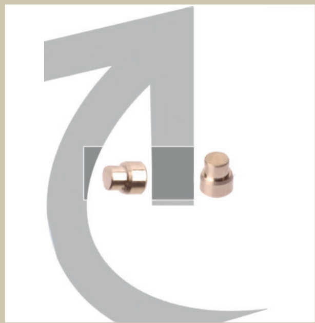
Bild 2. Diese Zylinder sollen hochkant gegriffen werden, befinden sich aber natürlicherweise öfter in horizontaler Position. Durch ein sauber abgestimmtes Spiel zwischen den richtigen Parametern der Frequenz, der Amplitude und des Signalbilds lassen sich die Zylinder aufstellen
