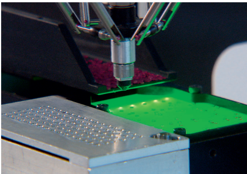
Bild 3. Die LED-Hintergrundbeleuchtung dient zur präzisen Erfassung der Bauteillage. Die Farbe des Lichts lässt sich an die Materialien anpassen
