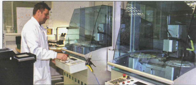
Machine de garnissage de composants horlogers chez TAG Heuer. Source : TAG Heuer
