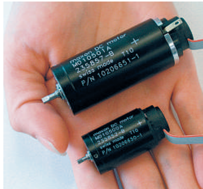
Die Motoren des Mars-Rovers mit Durchmesser 20 und 25 mm und einem Wirkungsgrad von über 90 Prozent sind fast Standardprodukte. Nur geringfügige Anpassungen waren nötig, damit sie den Temperaturwechsel auf der Marsoberfläche von -120^\circ\text{C} bis +25^\circ\text{C} , die Erschütterungen und die spezielle Atmosphäre aushalten. (Bild: maxon motor)
