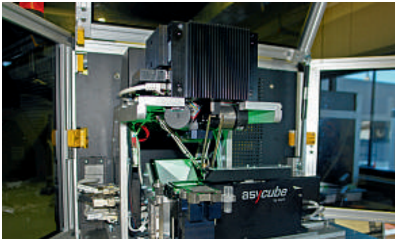
Asycube, das flexible Zuführsystem für Kleinkomponenten, dessen Plattform je nach Geometrie der Komponenten in eine oder drei Richtungen des Raumes vibriert. Dadurch werden Kleinstteile präzise für die Entnahme durch einen Roboter mit Bildverarbeitungssystem positioniert. (Bild: Elsbeth Heinzlmann)
