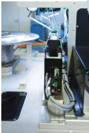
links und rechts oben: Der WEISS Rundschalttisch ist frei programmierbar und lässt sich über die WEISS Application Software (WAS) mit wenigen Klicks einrichten. Benjamin Burns von Asyri entschied sich für WEISS, den Rundtisch-Marktführer in der Schweiz.
