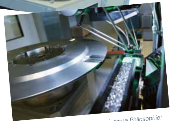
links und rechts oben: Der WEISS Rundschalttisch ist frei programmierbar und lässt sich über die WEISS Application Software (WAS) mit wenigen Klicks einrichten. Benjamin Burns von Asyri entschied sich für WEISS, den Rundtisch-Marktführer in der Schweiz.
